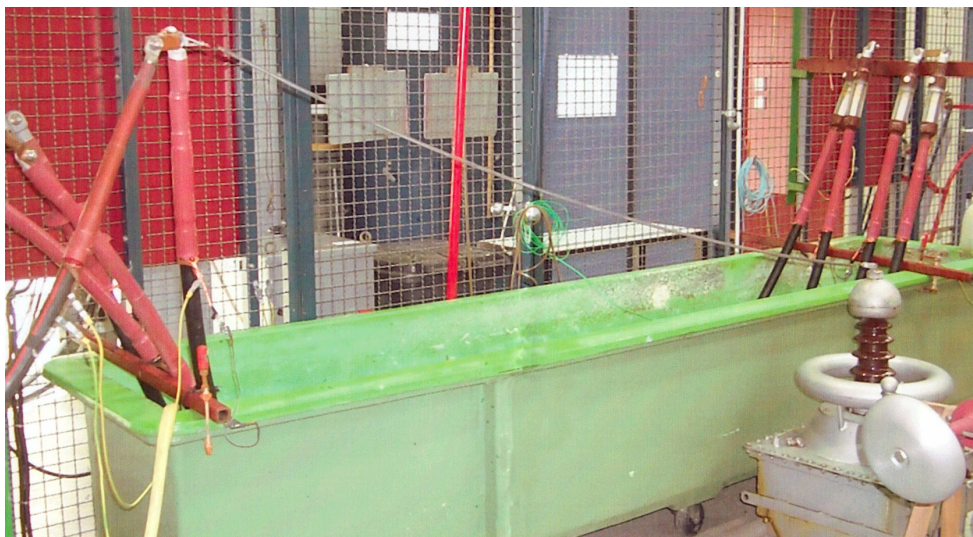
Slika 6. Provođenje dugotrajnih ispitivanja na uzorcima koji su potopljene u vodi
